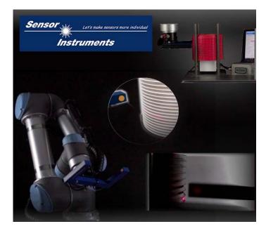
Лазерный датчик проходящего света при быстром и точном счете штабелированных крышек
